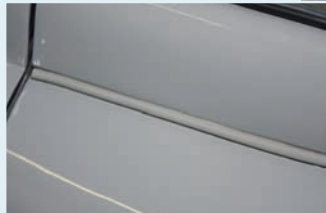
Weiterer potenzieller Rostherd: Befestigung der Kotflügel
