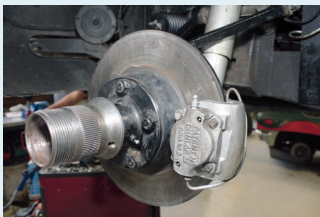
...und bei den Scheibenbremsen System Dunlop, welche ab 1957 gleich an allen vier Rädern verbaut wurden. Das war damals noch ziemlich revolutionär.
